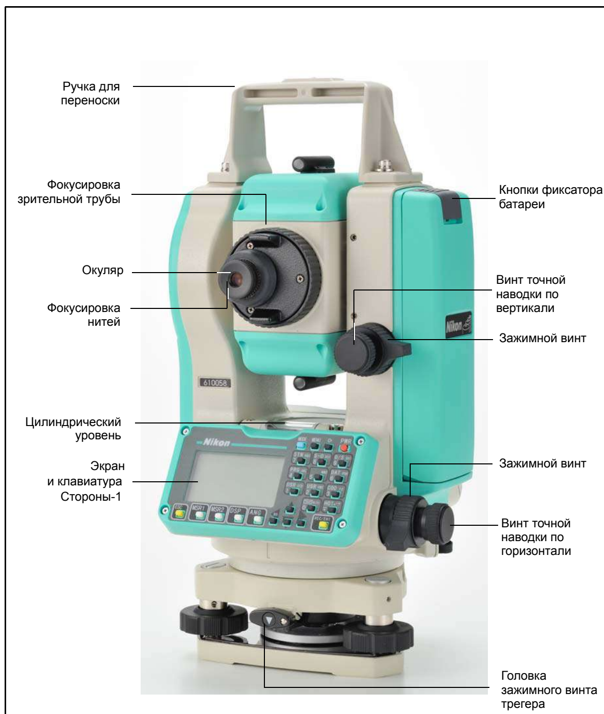
Рисунок 1.1 Электронный тахеометр DTM-322 – Сторона-1
